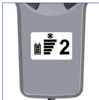
Vakionäyttö (kun kytketty päälle näppäimellä 2) » Ylämäkiavustin » Ajo-ohjelma 2 » Tukiporras » Akkukapasiteetti
