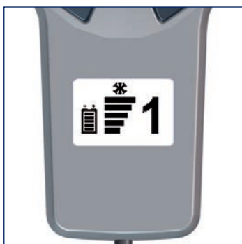
Vakionäyttö (kun kytketty päälle näppäimellä 1) » Ylämäkiavustin » Ajo-ohjelma 1 » Tukiporras » Akkukapasiteetti
